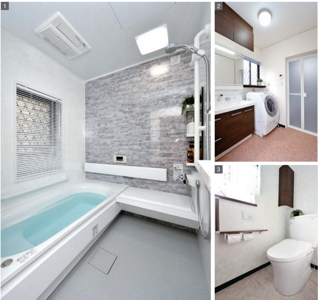
1 フットレスト付の浴槽は高い節水効果を保ちながら肩までゆったり。縁に溝があり安全な出入りをサポート。細部までやさしいバリアフリー設計。 2 洗面台はリクルのピアラ。必要な時だけ伸ばして使えるホース式のシャワーが便利。凹凸のない壁付け水栓は汚れにくくお手入れ簡単。対面にも置いていた収納棚を撤去しても収納力は十分です。3 TOTOの節水トイレピュアレストEX。使うたびに便器もノズルも自動除菌するので臭いも清潔。紙巻器の上のカウンターはひじ掛けにもなり立ち座りをサポート。
