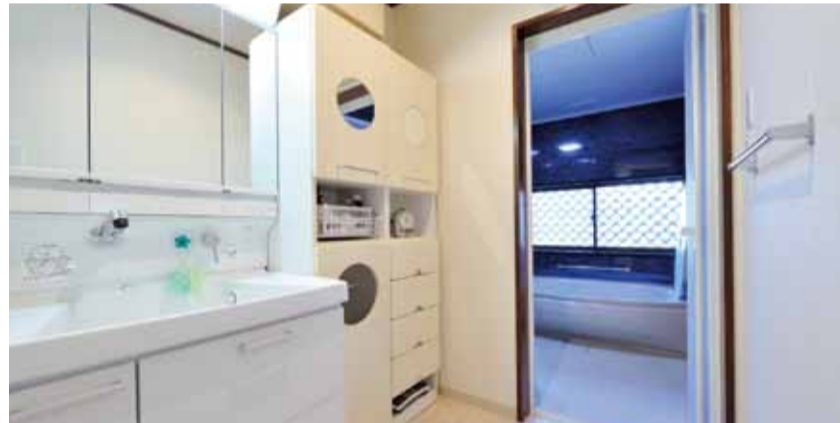
手前の洗面化粧台と手持ちのキャビネットがー列に並びように奥行きを30cmほど拡張、広くなった洗面室。洗面化粧台はTOTOオクターブシリーズ。
